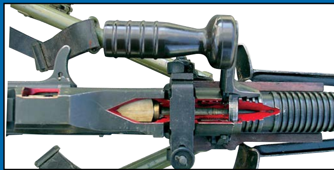
Détail de l'amortisseur de recul. (Document : Patrick Denamur)
