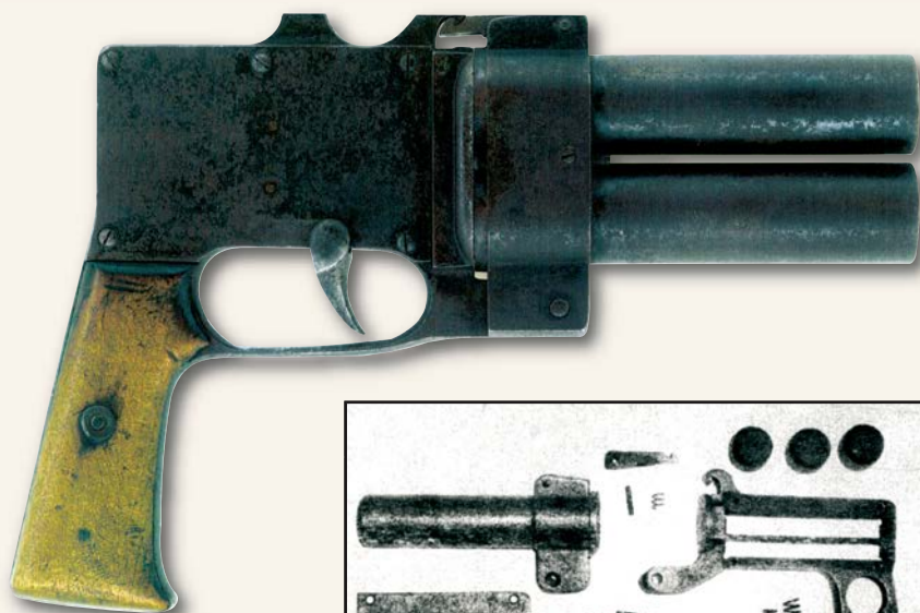
Modèle de remplacement à deux canons M 1918, vu de droite. Le mécanisme à double action se cache derrière une plaque démontable, tenue par 5 vis. Ce modèle est muni d'un pontet.
