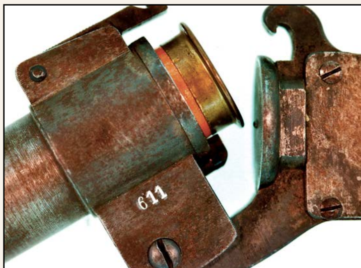
Détail du verrouillage du modèle 1917.
