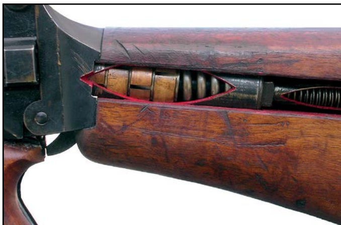
Mécanisme de démontage rapide du canon. (Document : Patrick Denamur)
