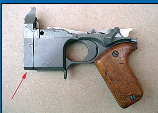
Gros plan sur la sous-garde d'un modèle DA1, permettant de distinguer nettement le bloc ajouté à l'avant du pontet. (Document : Patrick Denamur)
