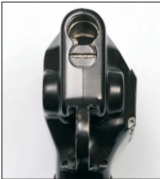
La vis sur le devant de la carcasse servant à fixer les canons.
