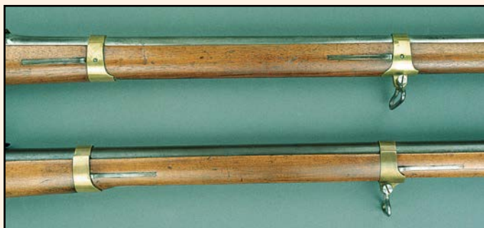
Des ressorts à pivot maintiennent en place la grenadière et la capucine du Dreyse 41. Pour le 1862 cette disposition est abandonnée au profit de ressorts à épaulement ce qui assure une fixation plus solide de ces garnitures.
