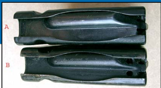
Comparaison entre le chargeur de calibre 30-06 du FN.30 mod. D (A) et celui en calibre 7,62 mm Otan du FAL et du modèle DA1 (B). (Document : Patrick Denamur)
