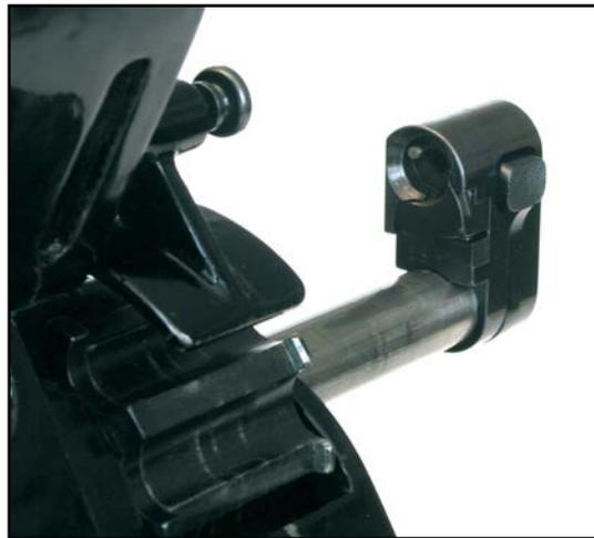
Vue du dispositif d'extraction des cartouches monté sur la tige de manoeuvre.
