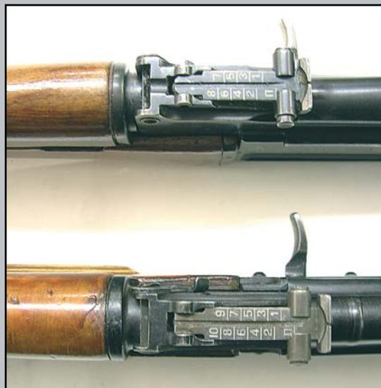
Comparaison entre la hausse graduée jusqu'à 800 mètres d'un AK 47 (A) et celle d'une AKM (B), graduée jusqu'à 1000 mètres.
