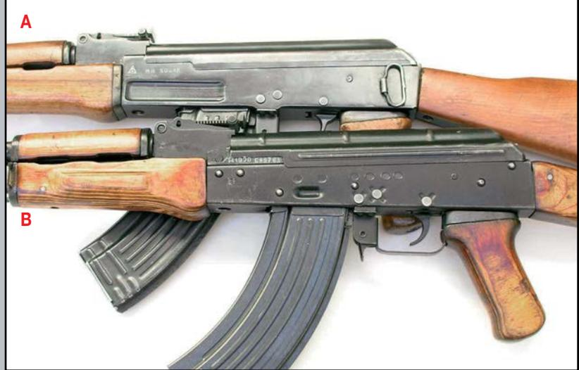
Le simple écrou de protection du filetage de bouche des AK 47 (A) est remplacé sur les AKM (B) par une pièce biseautée, servant de compensateur de relèvement. Ces pièces sont interchangeables, aussi peut-on rencontrer aujourd'hui des écrous d'AKM montés sur des AK et inversement. On notera également la différence de largeur des pieds de guides des deux modèles.
