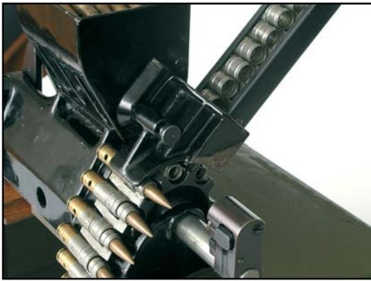
Détail du positionnement des maillons vides et garnis dans les alvéoles du cylindre principal lors du fonctionnement en mode de chargement des bandes.
