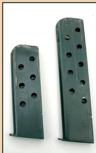
Comparaison entre le chargeur de sept cartouches du Browning 1900 (à gauche) et celui de sa copie chinoise, d'une contenance de 10 cartouches. On notera que ces deux chargeurs sont dotés à la base de leur face postérieure d'une encoche dans laquelle vient se prendre le bec du verrou de chargeur.
