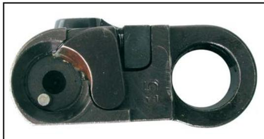
Détail du dispositif d'extraction des cartouches similaire à une tête de culasse avec extracteur et éjecteur.
